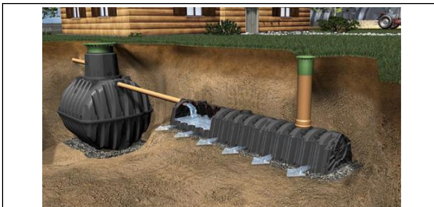
Obr. 37 Jímka s přepadem do vsakovacího objektu (zdroj: mmr.cz)
